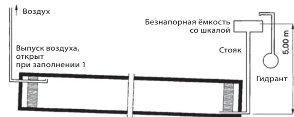
Между заполнением и испытанием трубопровода должно пройти достаточное время (1 час), чтобы оставшийся в трубопроводе после заполнения воздух мог постепенно выйти наружу. Испытательное давление измеряется в самой нижней точке испытываемого участка. Безнапорные трубопроводы должны прове-
